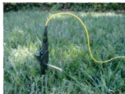
Рисунок 4: Подсоединение ST-305 к заземляющему штырю
