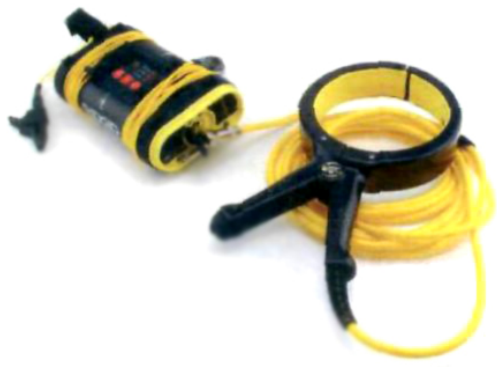
Рисунок 9: ST-305 с индукционными клещами
