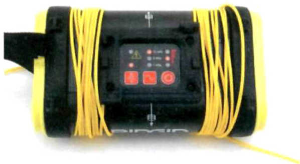
Рисунок 12: ST-305 в индуктивном режиме на частоте 33 кГц
