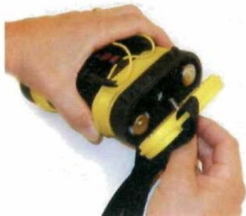
Рисунок 3: Снятие крышки с батарейного отсека
