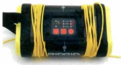
Рисунок 7: ST-305, установленный на 8 кГц и средний уровень мощности
