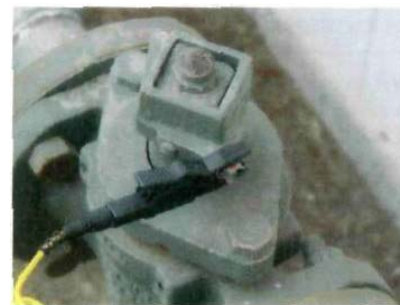
Рисунок 5: Подсоединение ST-305 к линии
